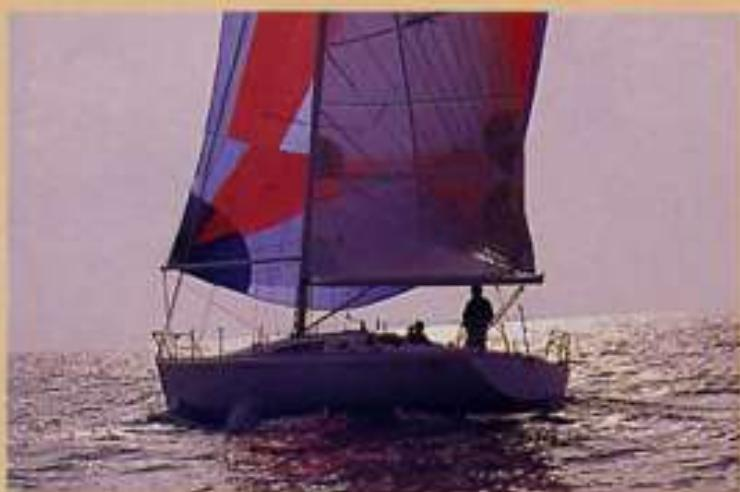
L'arma dell'Este 39 è un classico testa d'albero dotato però di una E molto allungata in modo da avere tutti i vantaggi di praticità e di rendimento di un frazionato ma senza essere penalizzato dalle
